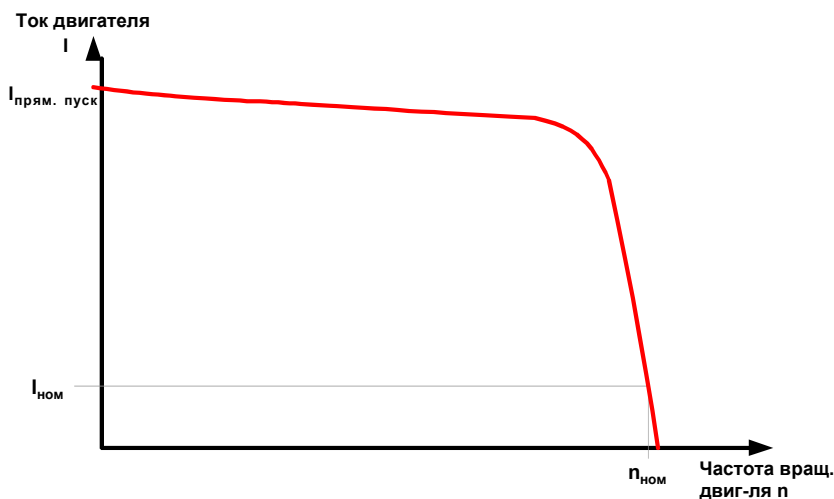
Рисунок 1-1: Типичные параметры пускового тока трёхфазного асинхронного двигателя
